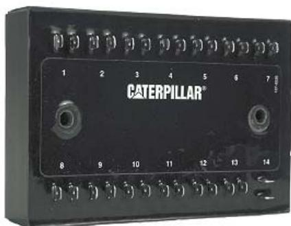
Модуль дополнительных реле (Relay Driver Module) позволяет получить девять дискретных выходных сигналов управления дизель-генераторными установками и машинными отделениями посредством коммуникационного модуля. Реле используется для включения звуковой или световой сигнализации запуска установки, запуска системы подачи воздуха, включения системы перекачки топлива, передачи сигнала о пуске на щит управления, а также для выполнения многих других операций.
