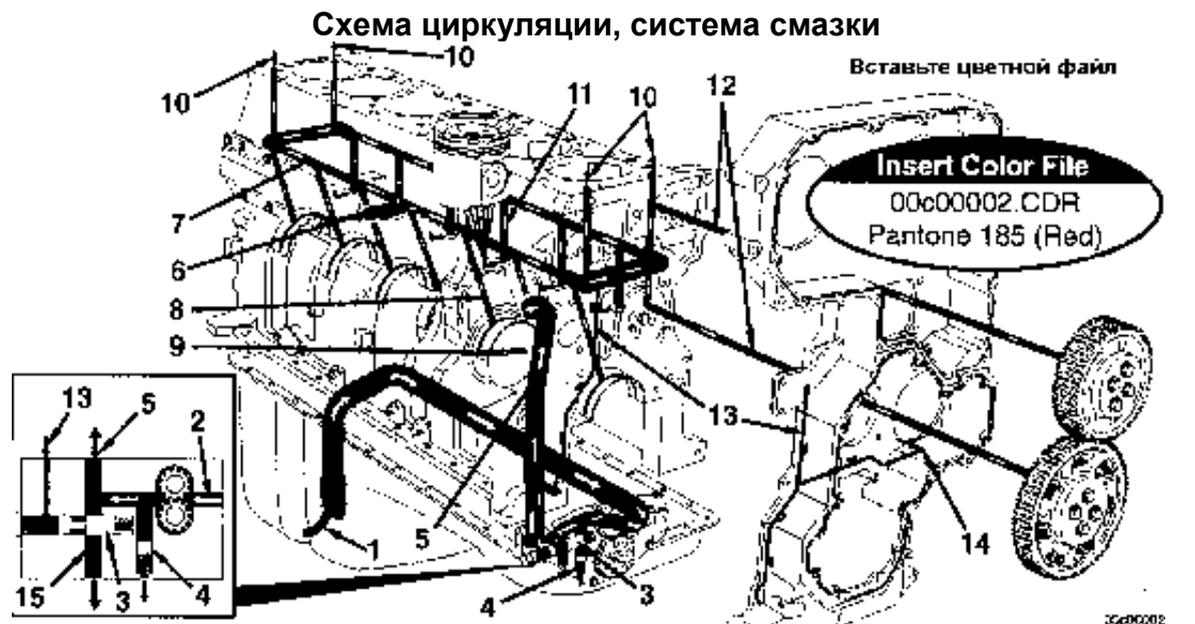
1. Подача смазочного масла от поддона картера через всасывающую трубку
