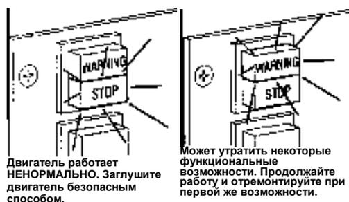
Двигатель работает НЕНОРМАЛЬНО. Заглушите двигатель безопасным способом.
