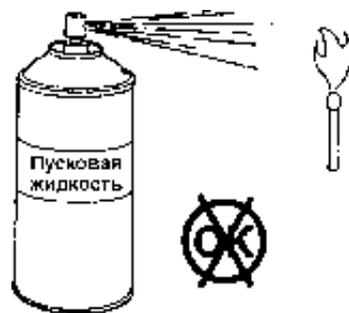
**Запуск двигателя в холодное время года с применением пусковой жидкости**
