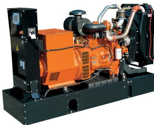
\*Основная мощность электростанции — это максимальная мощность, вырабатываемая генераторной установкой при переменной нагрузке вместо основной сети. В этом режиме не установлены ограничения продолжительности работы в течение года и допускается 10% перегрузка в течение одного часа каждые 12 часов работы генераторной установки.
